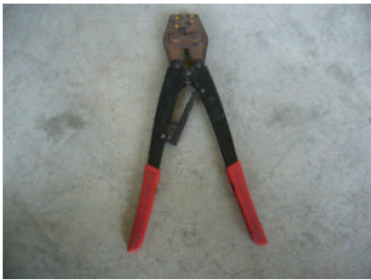
二 整理配線 三 剪線 夾端子
